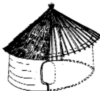
**La capanna rettangolare della foresta.** Sembra un compromesso fra i tre tipi precedenti: la capanna nomade per quanto riguarda i materiali e la leggerezza, la casa rettangolare per la forma e quella rotonda per l'inclinazione del tetto. Può avere un solaio sottotetto (come può averlo la capanna rotonda). Le parti più deboli sono spesso i frontoni e la base delle pareti, più esposta all'umidità. A volte può essere appoggiata su una leggera piattaforma che la stacca dal suolo.
