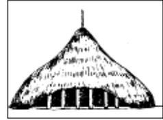
b.3 - Capanne staccate a pianta rettangolare. Telaio di 1-4 archi paralleli collegati da elementi orizzontali, legati alle estremità su pali fissati a forcelle di sostegno. Copertura di stuoie intrecciate. Usata molto spesso come una tenda portatile. La versione più grande è talvolta usata come casa fissa.
