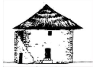
e.5 - Pianta circolare, su un'altezza da uno a tre piani. Costruzioni aggregate a formare case "a torre". Muri di terra impastata e compressa. Soffitti piani e solette intermedie fra i piani fatti con strutture di legno ricoperte di terra impastata con strame.
