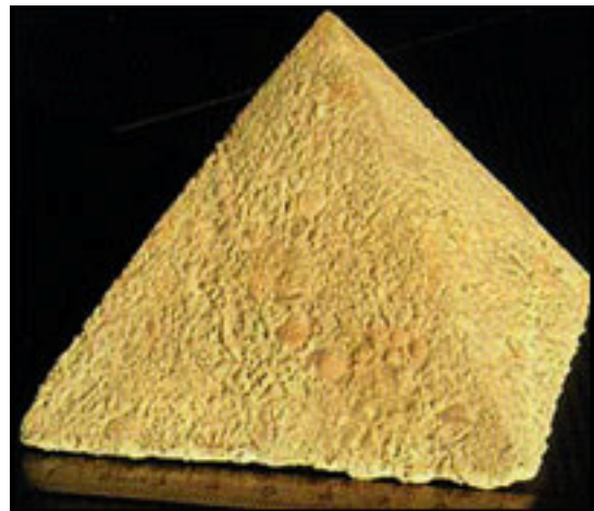
Esempio di blocco a forma piramidale realizzato con la tecnica elaborata da Davidovits ©www.geopolymer.org
